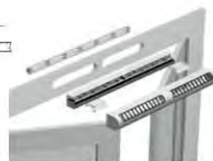
Montaggio ingresso aria nell'infisso
